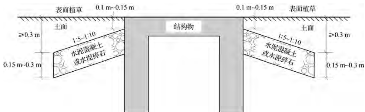
图 4.4.5-2 升降带平整范围内结构物的消除直立面措施示意图（一）
