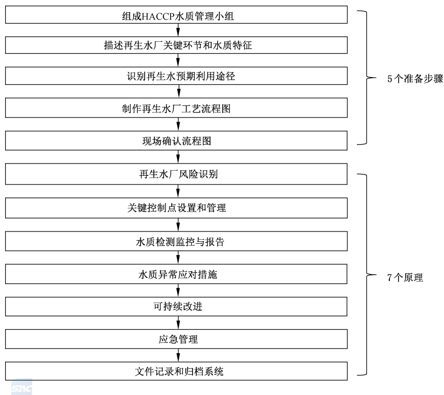
图 A.1 再生水厂风险分析与关键控制点(HACCP)体系水质管理措施制定流程
